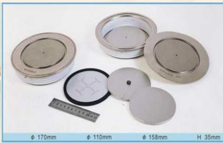
平板型晶闸管外形及结构
